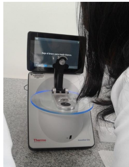
Fotografía 13. Capacidad Antioxidante (Medición en el Espectrofotómetro)
