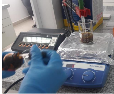
Figura 12. Proceso de agitación y ajuste a un pH de precipitación de 3.0, 4.0, 5.0, 6.0. (HCL)
