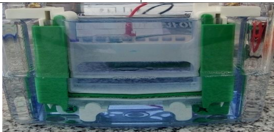
Figura 27. Migración de las partículas desde el cátodo hacia el ánodo
