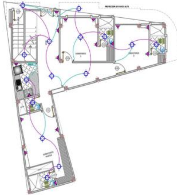
PLANTA ARQUITECTÓNICA BAJA INSTALACIONES ELÉCTRICAS ESCALA 1/100
