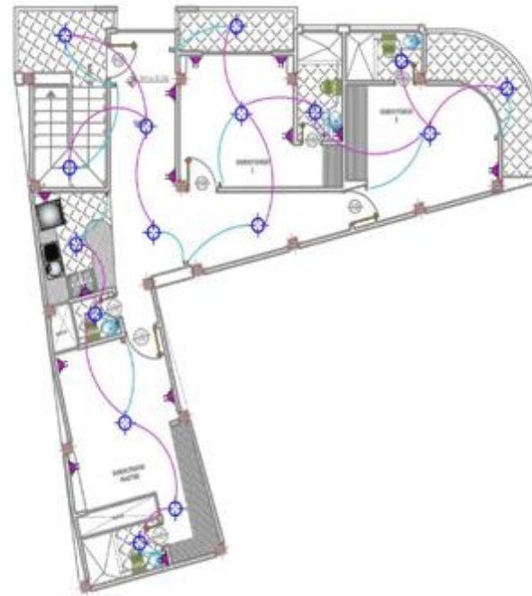
PLANTA ARQUITECTÓNICA ALTA INSTALACIONES ELÉCTRICAS ESCALA 1/100
