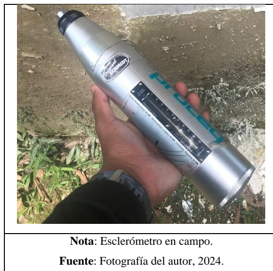
Fotografía 2: Trabajo in situ, esclerómetro
