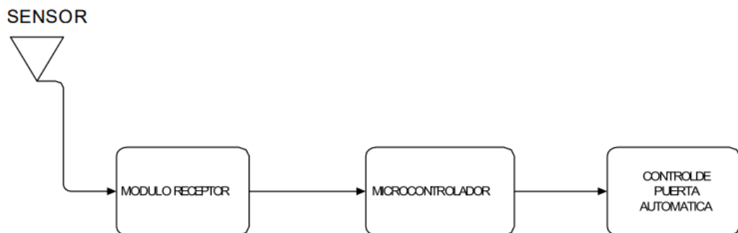
Figura 13 controlador de la puerta de garaje.
