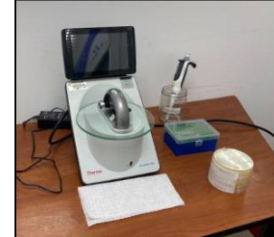
Foto 21: Materiales para ajustar la densidad de cada inculo a la escala de 0,5 McFarland
