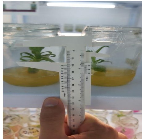
Fotografía 7. Toma de datos con la ayuda de un calibrador de vernier.
