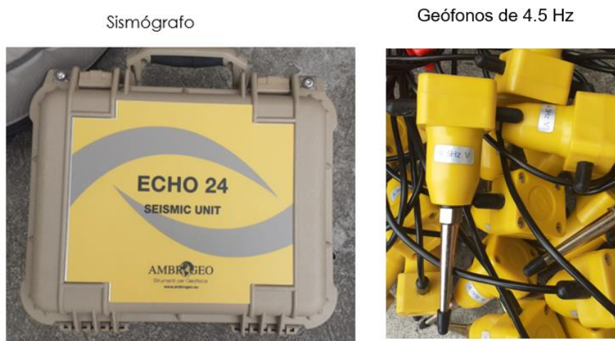
Figura 4: Prospección geofísica con sismógrafo y geófonos de 4,5 Hz con la instrumentación Ambrogeo.
