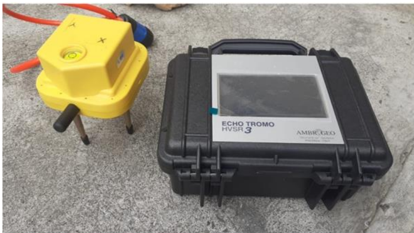
Figura 3: Sismómetro – acelerógrafo de marca Ambrogeo, empleado en la ciudad de Guaranda
