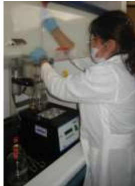
Adición de: Pastillas Kjeldahl, Peróxido de Hidrógeno, H_2SO_4
