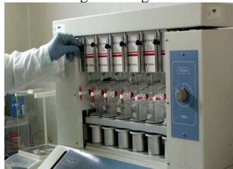
Digestor de grasa
