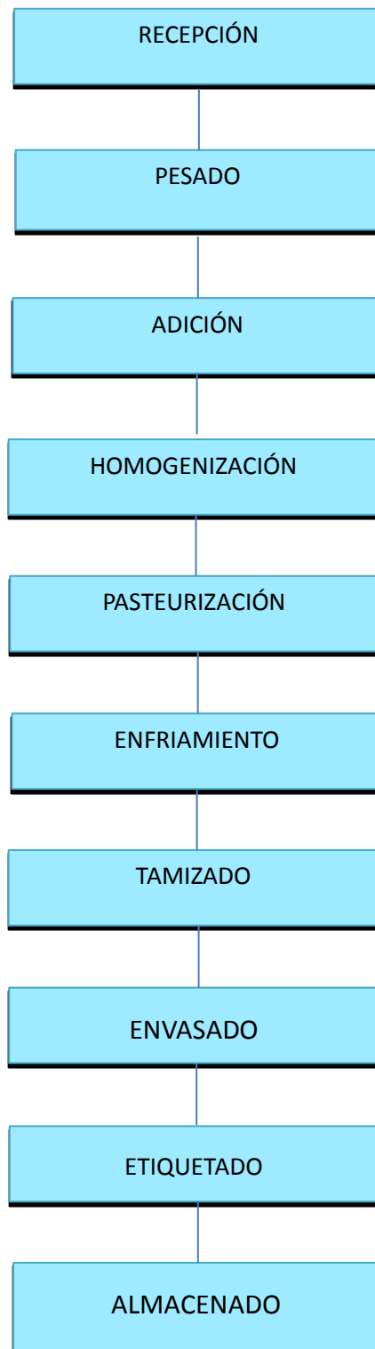
Figura 5: Diagrama de flujo para elaboración de la bebida de quinua.
