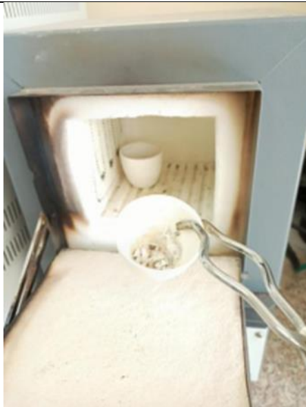
Determinación de humedad
