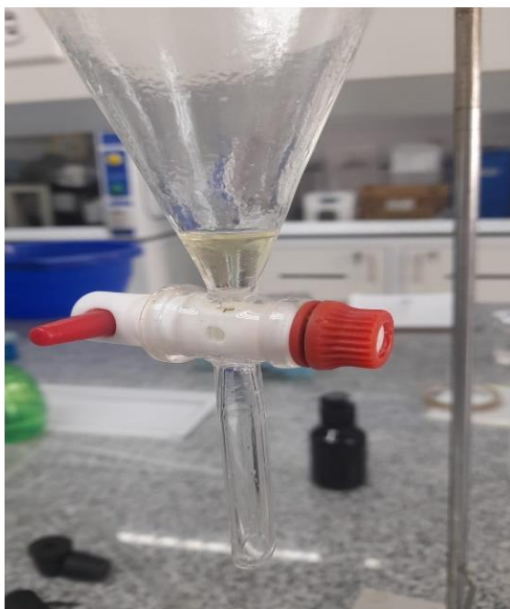
Separación el agua del aceite en el decantador
