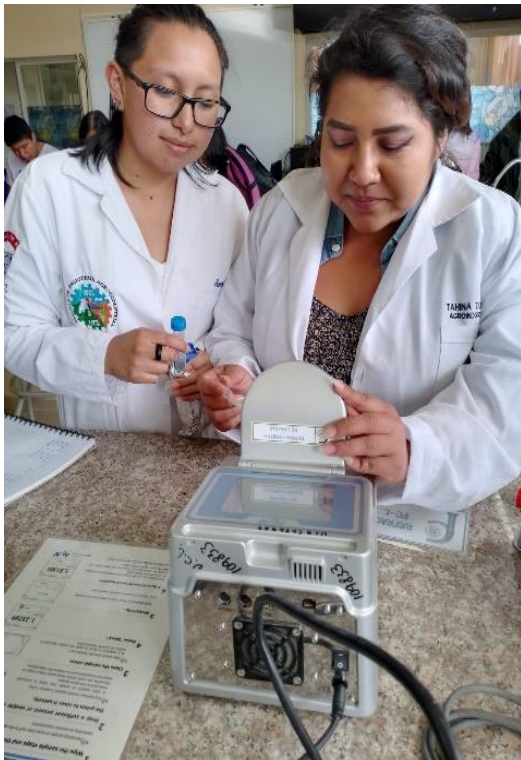
Realizamos el índice de refracción de los aceites esenciales
