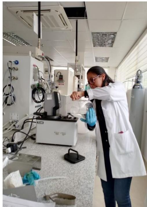
Baño maría con agua destilada, picnómetro para la densidad
