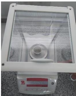
Peso de crisoles con las muestras incineradas y toma de datos
