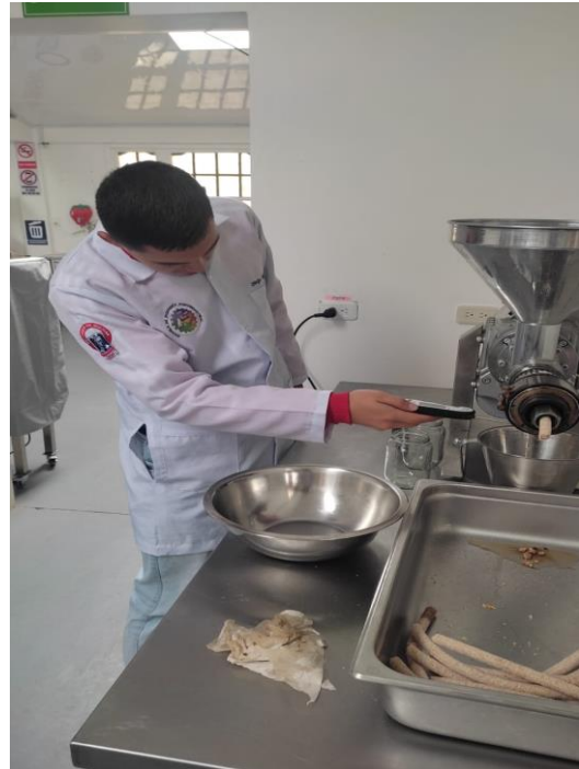
Control de temperatura en la extracción
