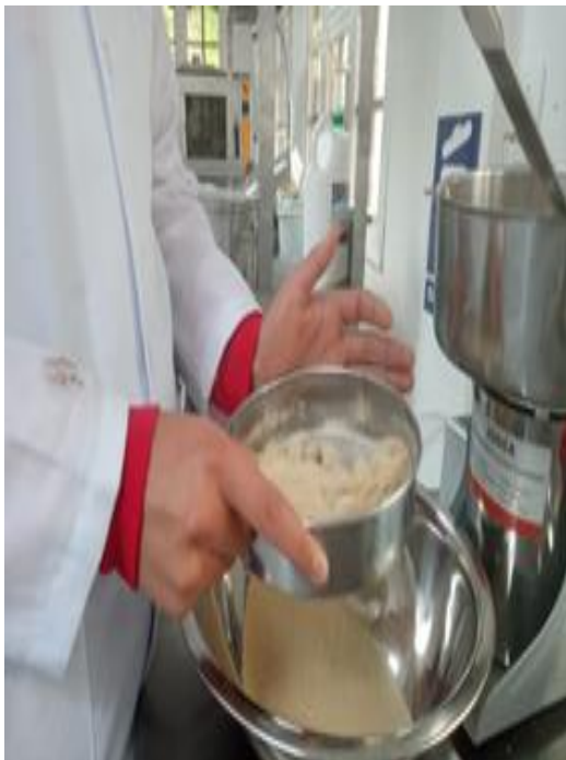
Tamizado de la torta residual
