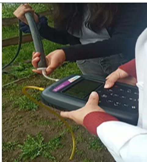
Calibración del equipo previo a medir el gas CH 4
