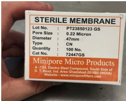
Foto 15. Membrana de microfiltrado
