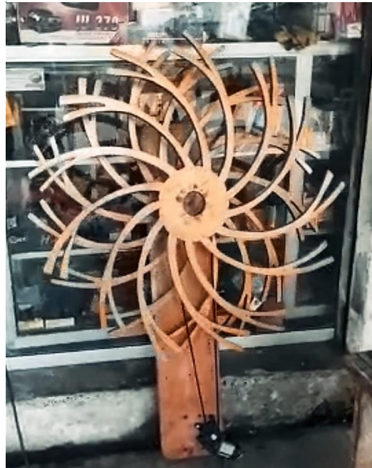
Ilustración 16 Instalación del motor y el convertidor
