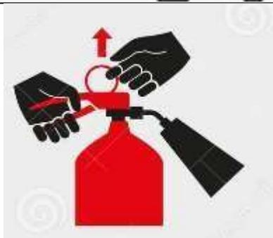
Desprecintar el extintor: Inclínándolo ligeramente hacia delante, sujetar la manguera con una mano y con la otra quitar el precinto. Efectuar un disparo de prueba para comprobar que el extintor funciona correctamente.
