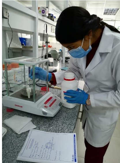
Gráfico 22: Paso 1 de la preparación de la solución ABTS
