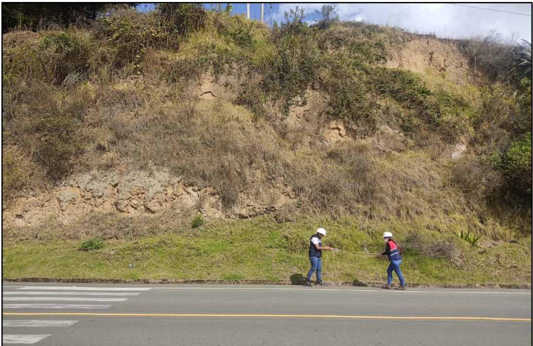
Fotografía N°. 6. Toma de medidas de longitud y altitud en los taludes localizados en la zona de estudio.
