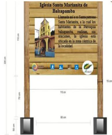
**Las Bases.** - Serán de hormigón de 20cm x 20cm con 50cm de plinto bajo tierra, con dos columnas cuadradas de madera de eucalipto ya que por la humedad este tipo de madera resulta mejor, de 15cm, de 2,20 de altura.
