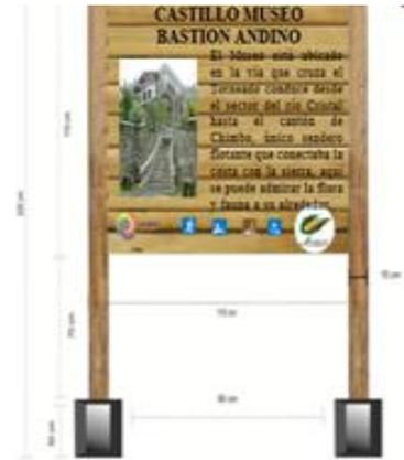
**Las Bases.** - Serán de hormigón de 20cm x 20cm con 50cm de plinto bajo tierra, con dos columnas cuadradas de madera de eucalipto ya que por la humedad este tipo de madera resulta mejor, de 15cm, de 2,20 de altura.
