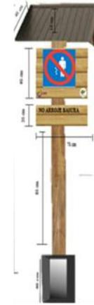
**Las Bases.** - Serán de hormigón de 20cm x 20cm con 50cm de plinto bajo tierra, con dos columnas cuadradas de madera de eucalipto ya que por la humedad este tipo de madera resulta mejor, de 15cm, de 2,20 de altura.
