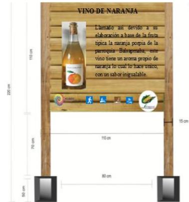
**Las Bases.** - Serán de hormigón de 20cm x 20cm con 50cm de plinto bajo tierra, con dos columnas cuadradas de madera de eucalipto ya que por la humedad este tipo de madera resulta mejor, de 15cm, de 2,20 de altura.
