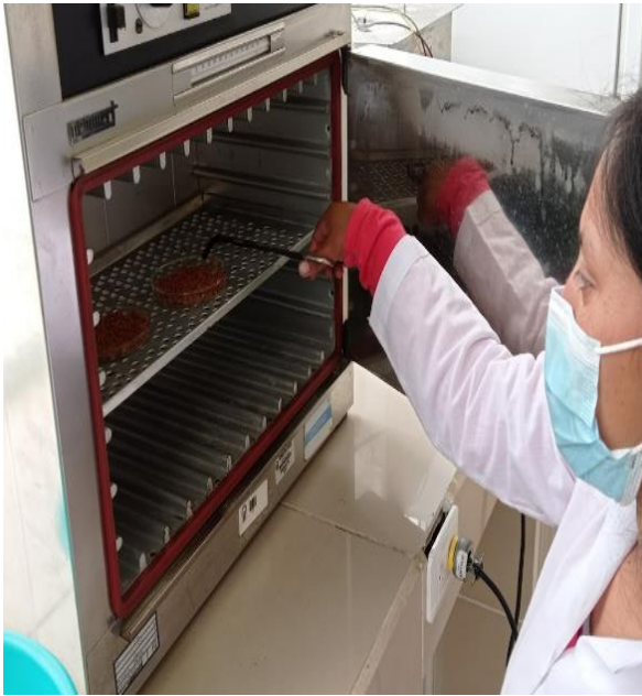
Estufa a 130°C por 2 horas Anexo 5. Determinación de cenizas
