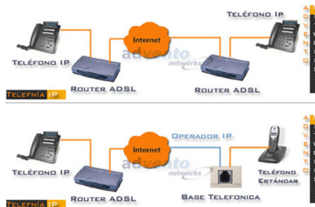
Gráfico 7: Esquema conceptual sobre el sistema VoIP.
