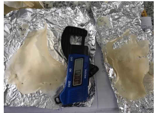
Medición de la muestra con micrómetro
