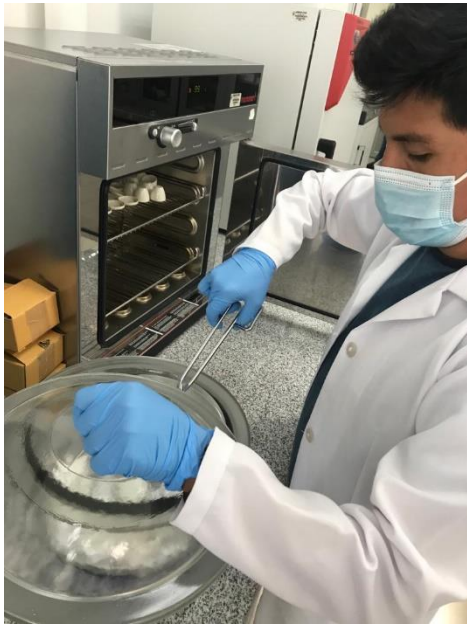
Secado de crisoles por estufa
