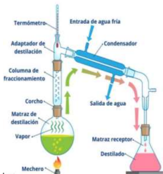
Figura 7. Equipo de destilación fraccionada.
