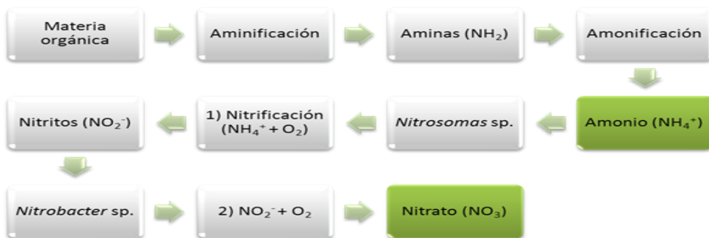
Figura 2. Transformaciones del nitrógeno en el suelo
