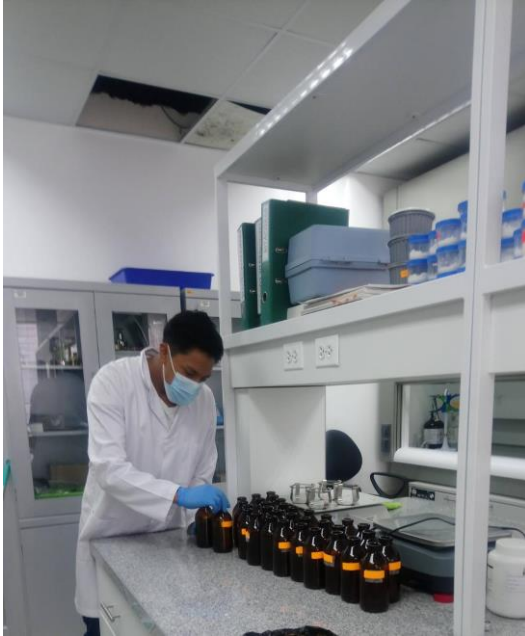
Fotografía 15.- Llenado de los digestores
