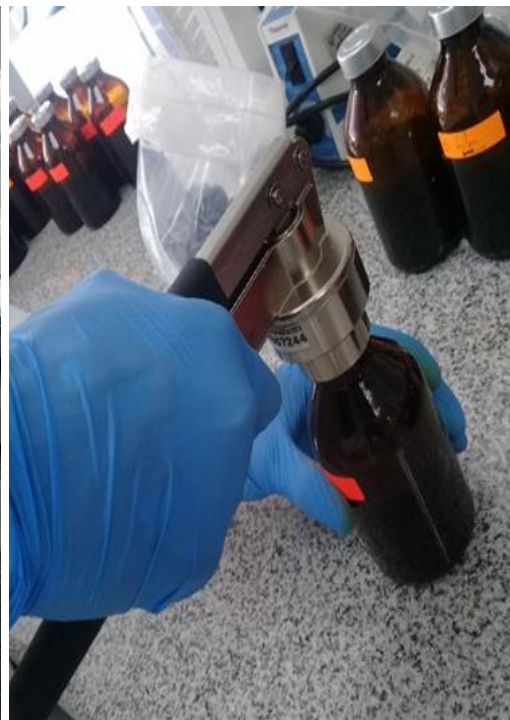
Fotografía 16.- Sellado de los digestores
