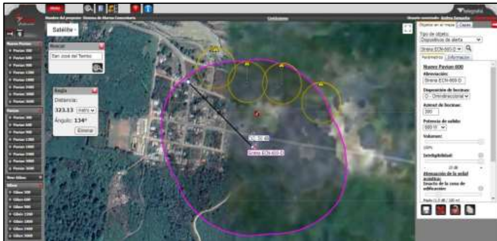
Figura 10 Visualización de la onda de propagación en la herramienta Acusticus Professional.
