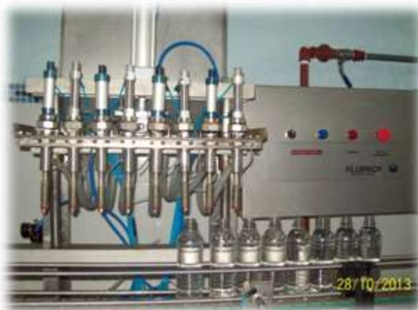
Permite envasar el agua, son envasados por medio de 8 válvulas o tubos con precisión, gravedad, peso y control de flujo, el llenado se hace sin ninguna corriente de aire ya que esto puede inferir con la calidad bacteriológica del agua principalmente.
