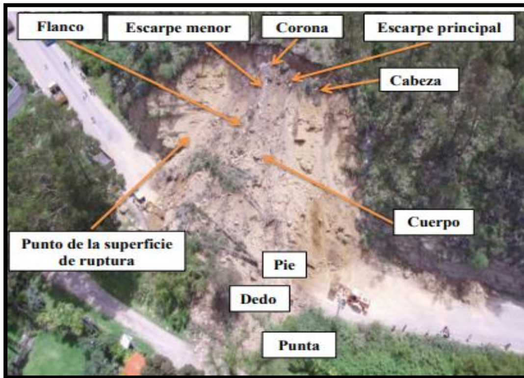
Figura 9: Partes de un deslizamiento
