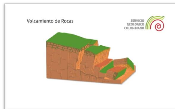
Imagen 3 Tipo de deslizamiento: Volcamiento de rocas
