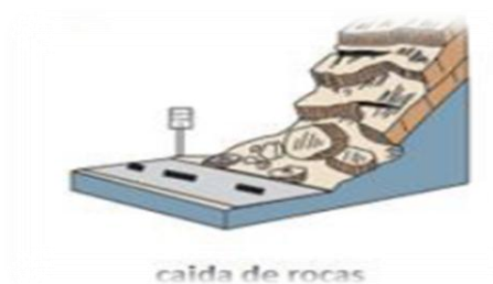
Imagen 2 Tipo de deslizamiento: Caída de rocas
