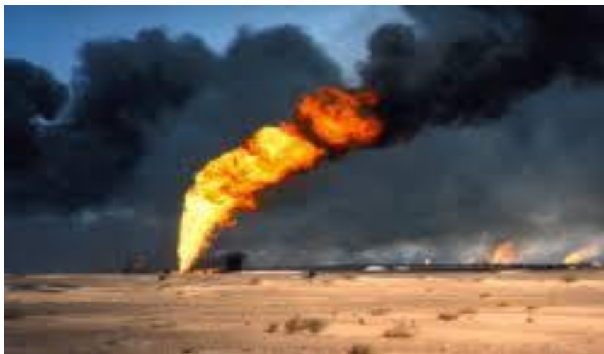
Gráfico 6. Jet fire, es una fuga accidental de vapores o gases inflamables a presión
