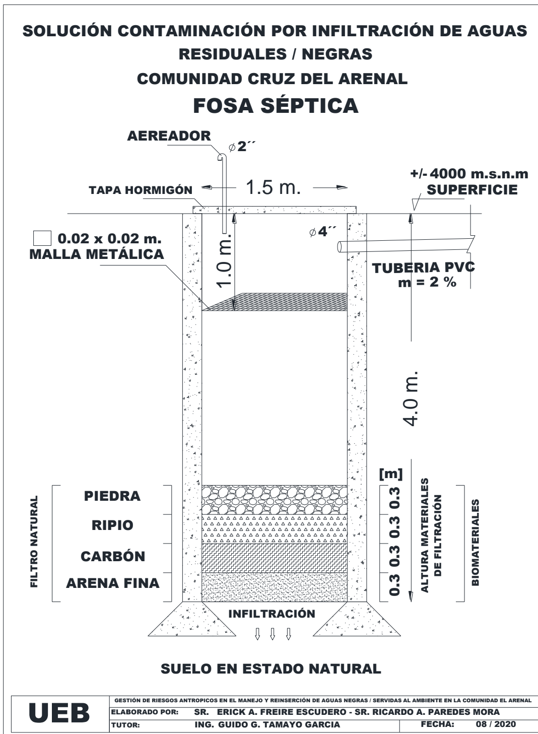
Figura 9: Propuesta diseño fosa séptica para las viviendas de la comunidad El Arenal.
