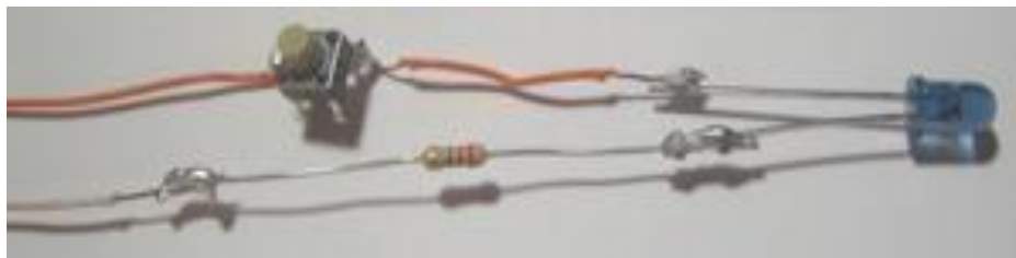
Soldaduras en las terminales de los elementos
