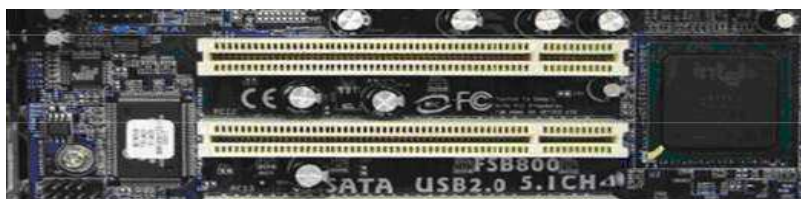
Localización de una ranura PCI
