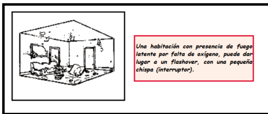
Imagen 4: Ejemplo de propagación del fuego. Fuente: Guía del Bombero Profesional Protección contra incendios.
