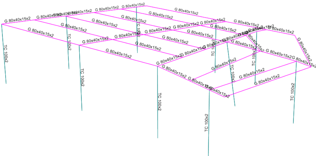
Figura 4. Columnas y correas (estructura metálica) – segundo piso alto
