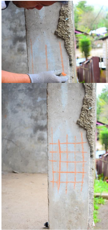
IMAGEN 22. Limpieza y dibujo de la grilla de 4x4 para las pruebas de esclerometría.
