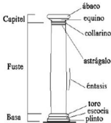
Figura 8: Las partes esenciales de una Columna.
