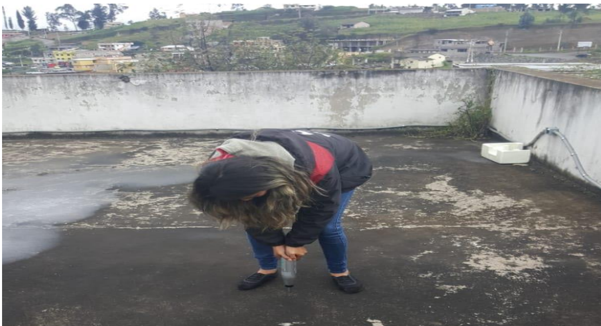
Fotografía 10: Recolección de información losa (Esclerómetro) Autores: Andrade y Escobar, 2019 Fecha: 02/04/2019
