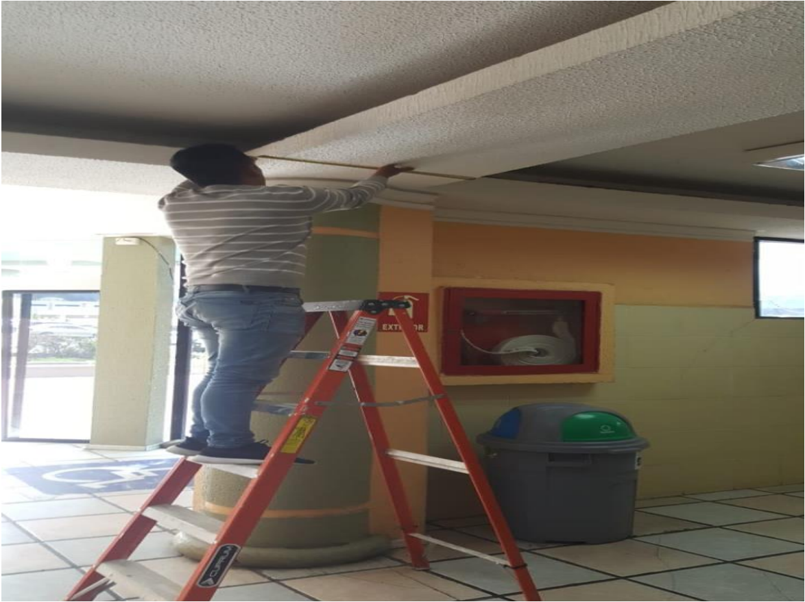
Fotografía 12: Recolección de información vigas (Esclerómetro) Autores: Andrade y Escobar, 2019 Fecha: 02/04/2019
