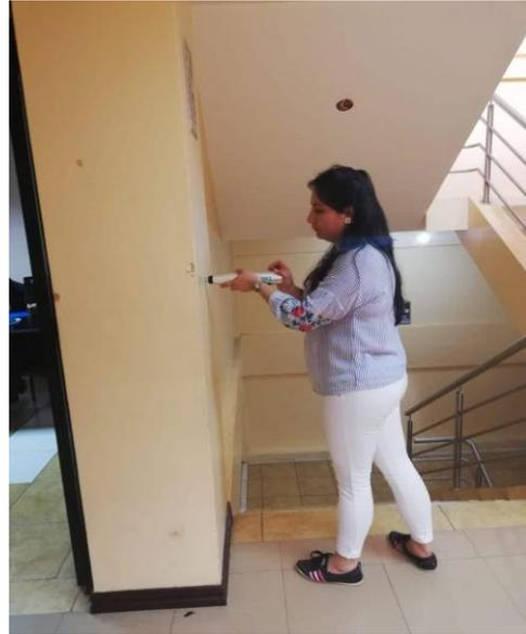
**Fotografía 10 :** Obteniendo valores con el esclerometro en los elementos estructurales.
