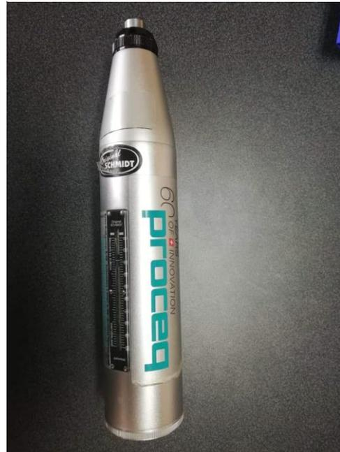
**Fotografía 12 :** Esclerometro herramienta para el levantamiento de información.
