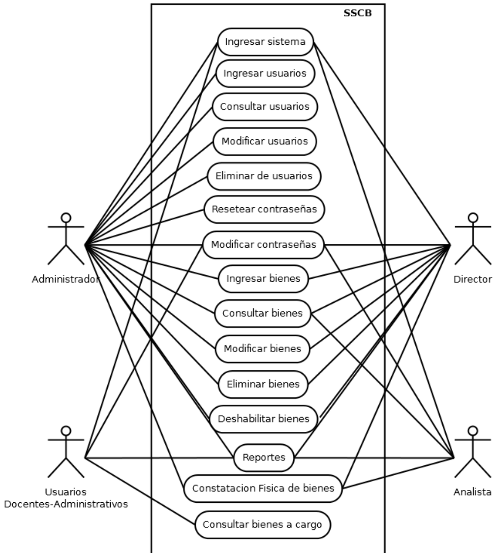
Gráfico N°24: Diagrama de casos de uso del sistema Elaborado por: Byron Rene Poma Tamami
