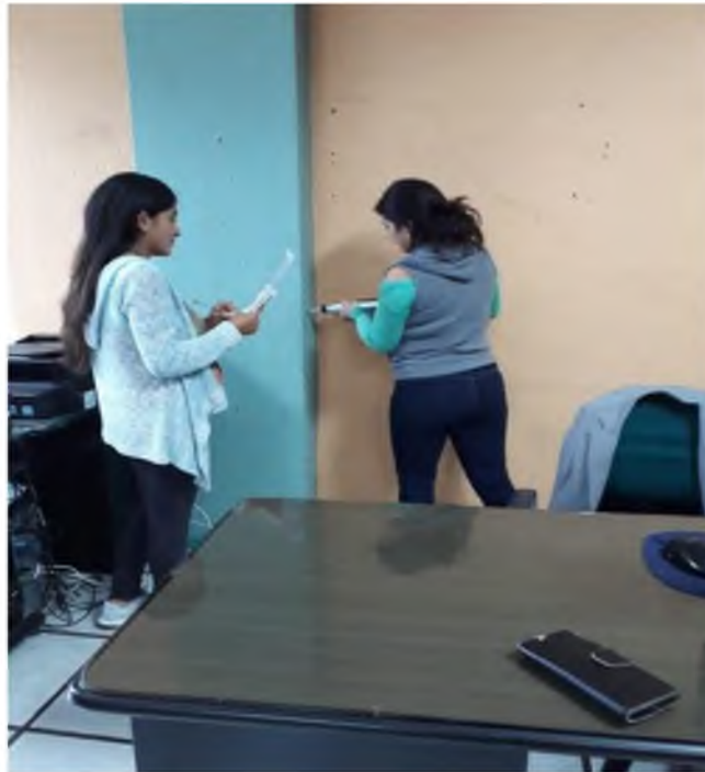
Anexo 15: Medición de resistencia, Test Hammer Fuente: Trabajo de campo, 2019 Autores: Pazmiño y Pico
