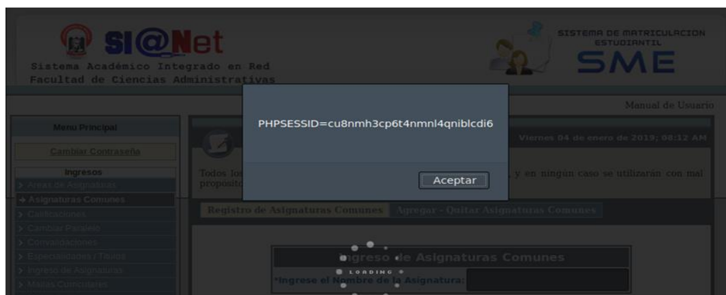
Figura 71. Verificación de Cookie no HttpOnly Flag. (Elaborado por el autor)
