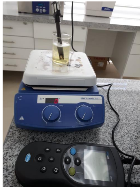
Cambio de pH de las muestras con el phmetro y el agitador magnético.
