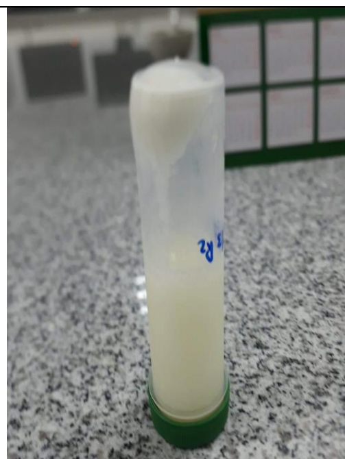
Colocación de la muestra de pH 5.8 a los tubos de plástico para la centrifugación.
