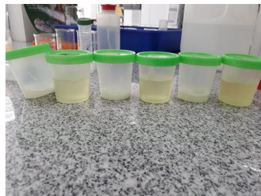
Muestras salidas del centrifugador (precipitado y sobrenadante)
