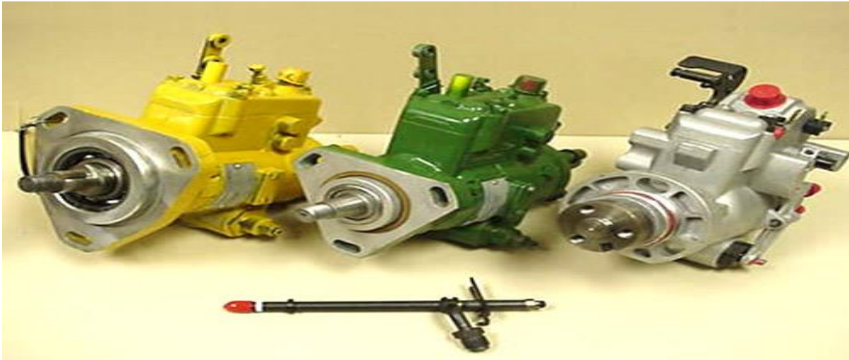
Figura 2: Mantenimiento y reparación de bombas de inyección
