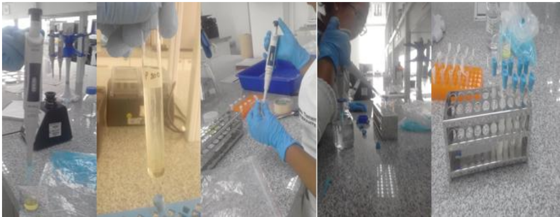
Figura 8: Colocando en un tubo de ensayo 2mL de albumina de huevo, 2 mL de patrón diluido (muestra), 2,8 mL de tampón fosfato y agitamos
