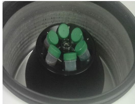
Figura 4: Proceso de centrifugación a pHs de solubilización 8.0 y 10.0
