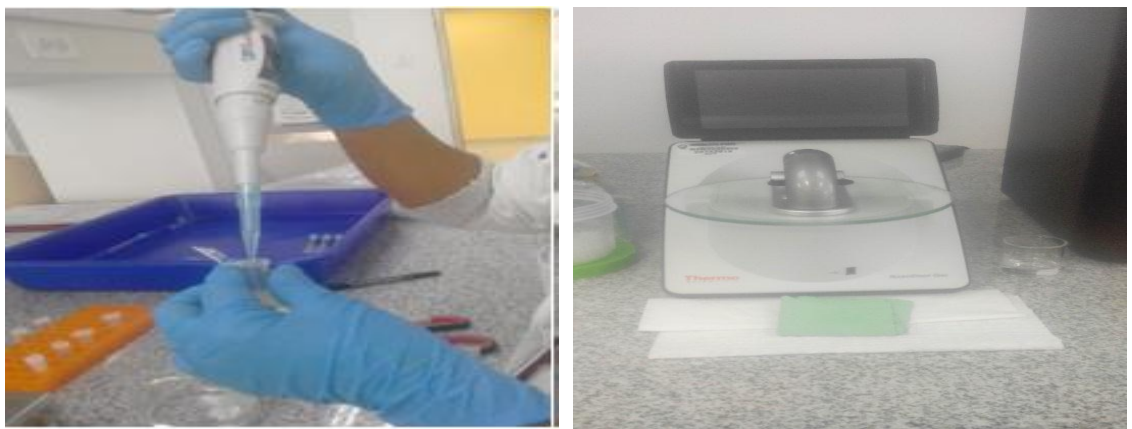
Figura 11: Midiendo la absorbancia de la muestra en el espectrofotómetro
