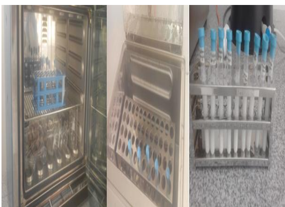
Figura 9: Colocando las muestras en una incubadora, luego en el baño maría finalmente sacamos y dejamos enfriar
