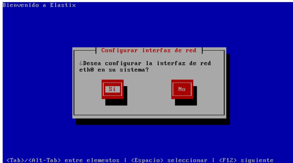
**Figura 7.15:** Pantalla para confirmación de configuración de red
