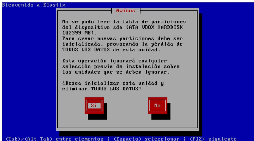
**Figura 7.12:** Crear particiones en el dispositivo (Disco duro).
