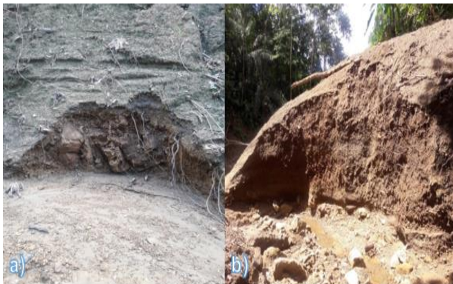
Fotografía 17. a) Afloramiento lutítico y en la parte superior arcilla con material orgánico, b) Arcilla limosa y material orgánico.
