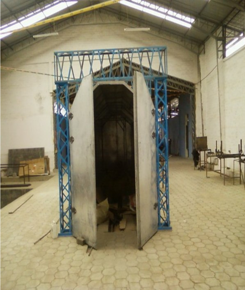
Puerta del horno industrial
